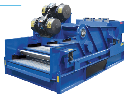
Вибросито KING COBRA VENOM с системой автоматической регулировки силы G (CONSTANT G-CONTROL™ - CGC)
